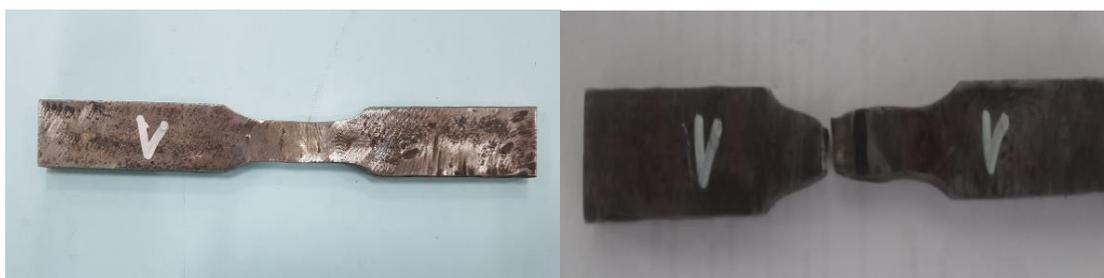
Gambar 2. Spesimen Kampuh V dan Hasil Uji Tarik
