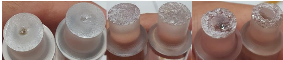
Gambar 7. Permukaan patahan spesimen dengan durasi waktu gesek 15, 30, dan 45 detik.
